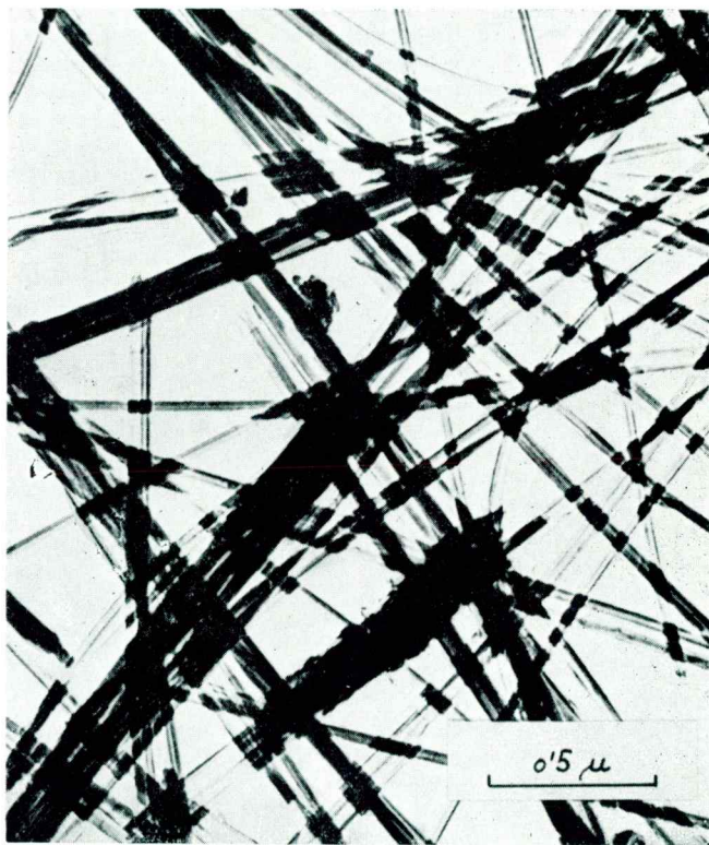
2. sl. Elektronski mikroposnetek rujištanskega azbesta pri 40.000-kratni povečavi Fig. 2. Electron microscope picture of the Rujište-asbestos, 40.000 diams.
