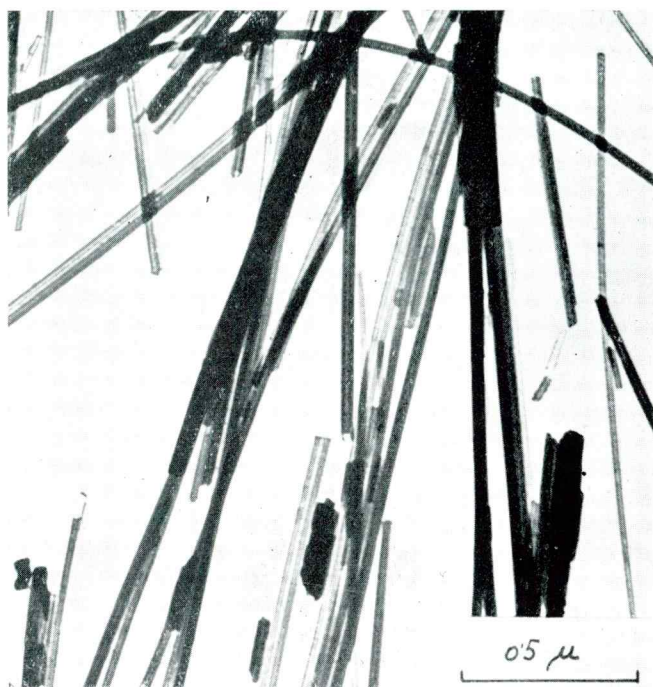
1. sl. Elektronski mikroposnetek korlačanskega azbesta pri 45.900-kratni povečavi Fig. 1. Electron microscope picture of the Korlača-asbestos, 45.900 diams.
