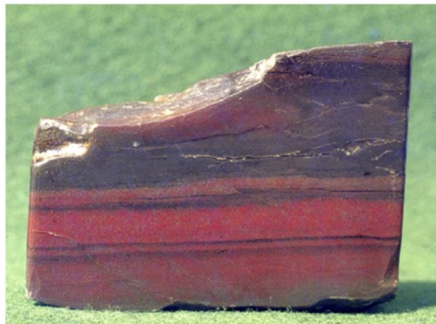
Sl. 11. Vzporedno laminiran langobardski tufit. Menjavajo se lamine in tanke plasti s postopno zrnastostjo orudenih kalcedonskih zrn in piroklastičnega materiala. Kropeč IIm/8. Velikost vzorca 10 x 6,5 cm (levi rob vzorca). Foto: Rafael Podobnik
