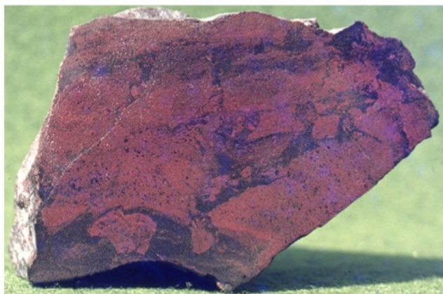
Sl. 16. Brečasta cinabaritno-kalcedonska opekovka, nastala zaradi sinsedimentnega drsenja in lomljenja. Kropáč II/7. Velikost vzorca spodaj 8 cm, višina 11 cm. Foto: Rafael Podobnik
