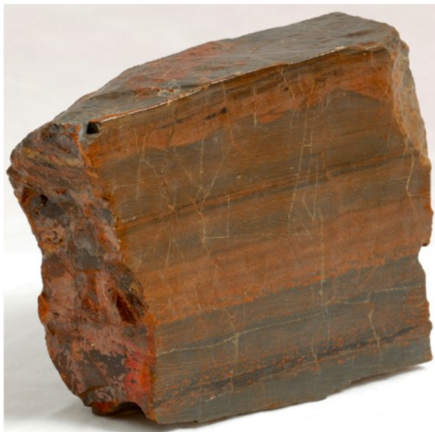
Sl. 19. Laminiran tufit. Zrna kalcedona prepojena s cinabaritom v tufitu. Zgoraj vidimo bolj ali manj razvito obremenitveno teksturo. Nekaj delcev se je že skoraj odvojilo od zgoraj ležeče plasti in gradijo teksturo 'pogreznjenih delcev'. V sredini in spodaj različno razvite postopne zrnivosti. Velikost vzorca 13 x 14 cm. Odkopno polje Kropač I/19. Foto: Jani Peternej
