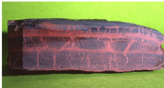
Sl. 20. Bituminozni meljavec s številnimi orudenimi kalcedonskimi zrn in lamine cinabarita sekajo postsedimentne razpoke zapolnjene s cinabaritnim gelom. Razpoke so nastale še v mehkem sedimentu. Odkopno polje Kropač II/7. Velikost vzorca 9 x 3,5 cm. Foto: Rafael Podobnik
