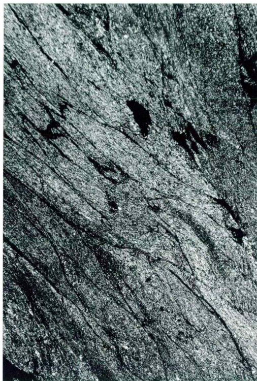
Sl. 5. Mikroskopski izgled lečasto-luskasto razpokanega glinastega skrilavca vzdolž značilne prednostne orientacije filosilikatov (prevladuje sericit). Viadukt Log, +N, 20 ×.
