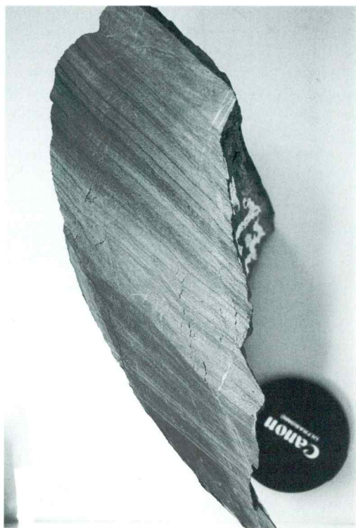
Sl. 1. Tanko do mikro-laminirano menjavanje glinastega skrilavca in zelo šibko metamorfoziranega peščenega meljevca. Odlomna ploskev seče kompetentne lamine prečno in povija v smeri s_1 ter s_0 v nekompetentnih laminah. Predor Golovec.
