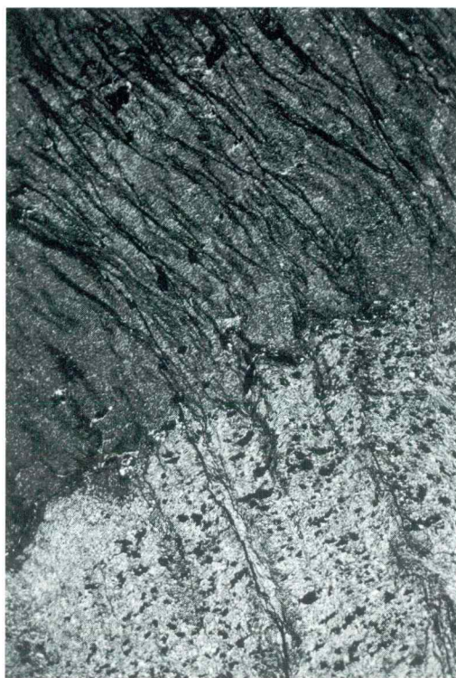
Sl. 2. Sekundarna skrilavost s_1 s koncentracijami neprosojnih mineralov poteka prečno na plastovitost s_0 . Glinasta lamina se je močnejše deformirala kot meljasta. Nastaja plisiran klivaž. Viadukt Vranke, VR-761, +N, 8 x.
