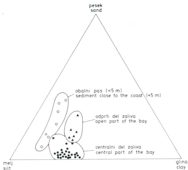
Sl. 5. Diagram zrnivosti pesek-melj-glina površinskega sedimenta Koprškega zaliva
