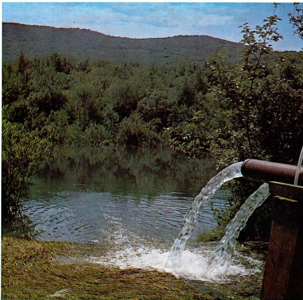
Fig. 15. Essai par pompage sur le forage VB-4/81. Débit 55 l/s
