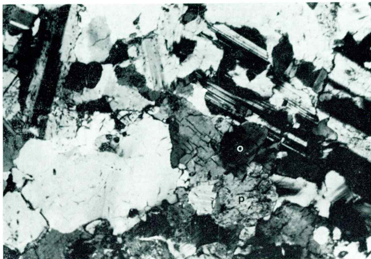
Sl. 1. Plagioklaz (p), ki ga delno nadomešča kalijev glinenec (o). Razkolne razpoke so v obeh glinenecih vzporedne in ustrezajo (001). Pegmatit, Ravne na Koroškem, 37 ×, nikola +
