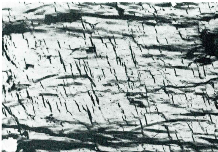
Sl. 1. Pertit. Vzporedna vlakenca (temno) v mikroklinu predstavljajo albit. Pegmatit, Ravne na Koroškem, 37 \times , nikola +
