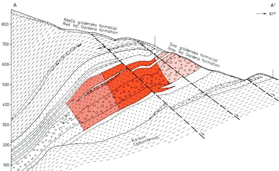
Sl. 3. Presek A—A' skozi bistvene dele geokemične celice: oksidirano notranjost, obogateni robni del in neoksidirano zunanjost
