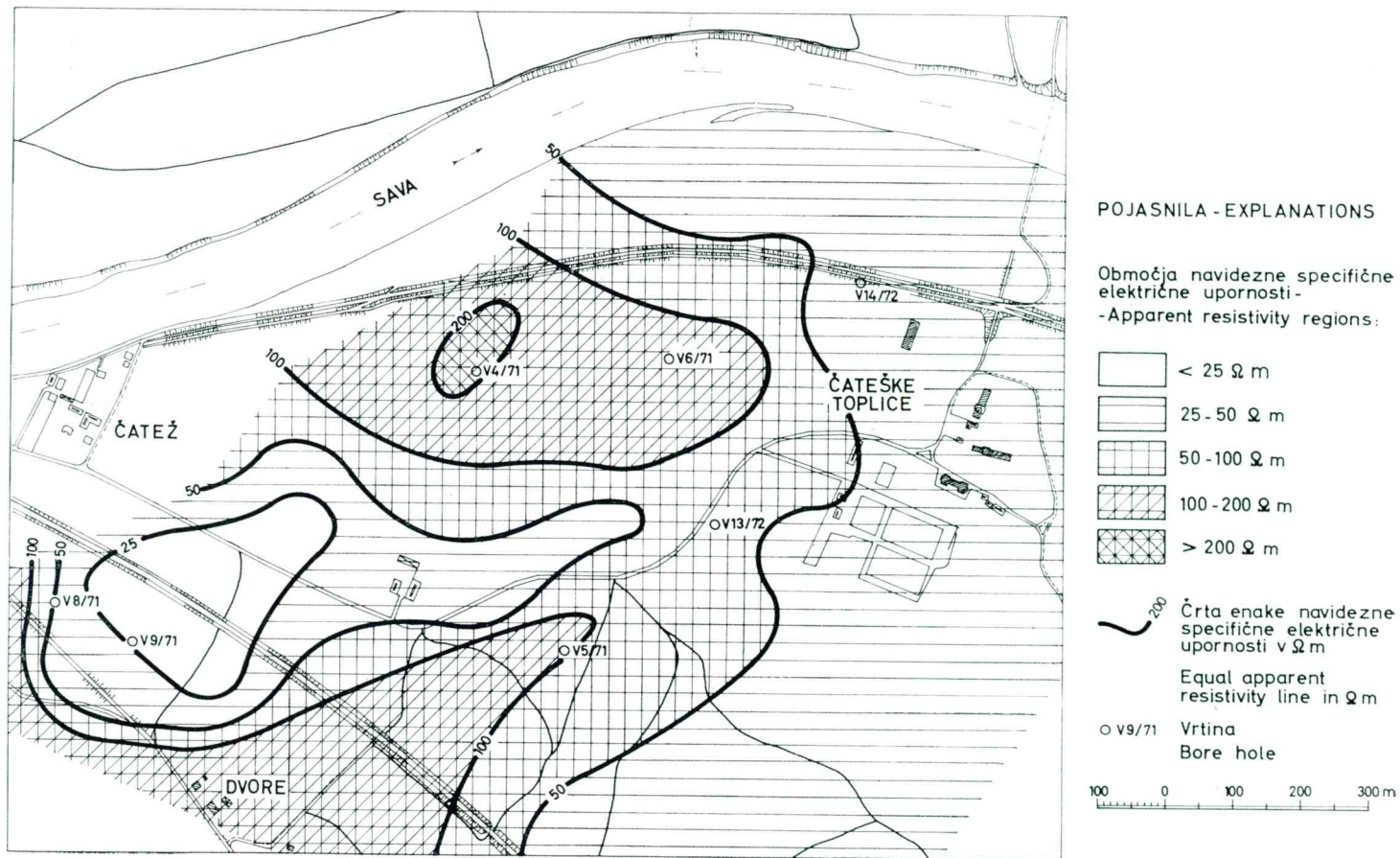
Sl. 4. Karta navidezne specifične električne upornosti za tokovni dipol AB = 240 m
