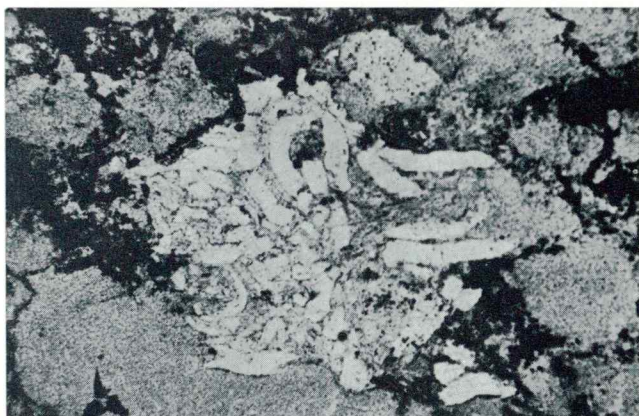
Sl. 6. Kaolinitna zrna s črvičastimi preseki v kriptokristalnem kaolinitu. Rudno telo Hangend, VII. obzorje, 4. etaža, vzorec 4. Presevna polarizirana svetloba, povečava 30 ×
