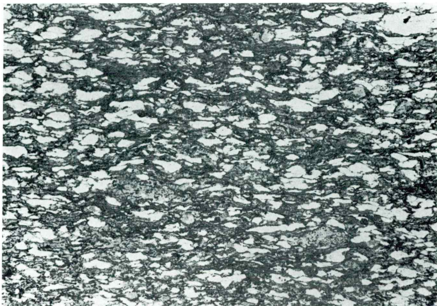
Sl. 11. Kaolinitna pšena (belo) leže ločeno v karbonatno-kremenovem vezivu (sivo), Pri slepem jašku št. 16, II. obzorje, vzorec 6. Presevna polarizirana svetloba, povečava 7\times
