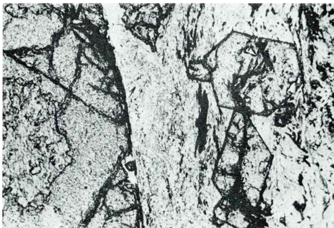
Sl. 1. Zelenkast kloritno muskovitni blestnik s porfiroblasti granata, velikega 1 cm. V granatu vključek kloritoida. Iz sericitnega agregata raste potektonski stavrolit z vključki grafita, ki nakazujejo prvotno plastovitost. Vzorec 25282/24680, 41 ×, nikola //, Kozjak.
