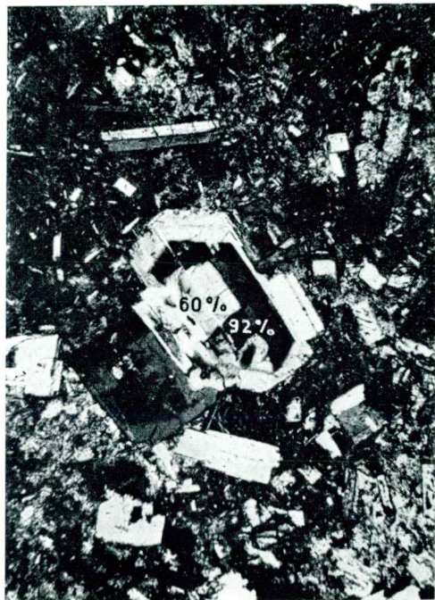
Sl. 6. Vz. 13 048/11 680, vzhodno od kmetije Brložnik, Smrekovec. Nikola +, 35 X. Hipersteno-avgitni andezit z zelo drobnazrnato osnovo. V plagioklazu je viden ostanek bazičnega magmatsko korodiranega jedra
