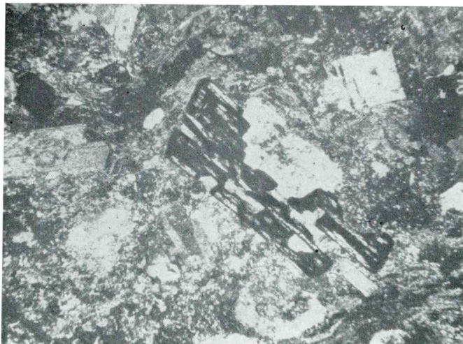
Sl. 9. vz. 1 116 b 1 /12—189, nikola +, 35 ×, Drmalka. Zelenkast ignimbritni tuf, sestavljen iz plovčevih fragmentov ter vtrošnikov albitiziranega in kalcificiranega plagioklaza. Vidimo tudi vtrošnik magmatsko korodiranega biotita. Osnova je sestavljena iz steklastih fragmentov in vulkanskega prahu, ki so delno kristalizirani in kalcificirani
