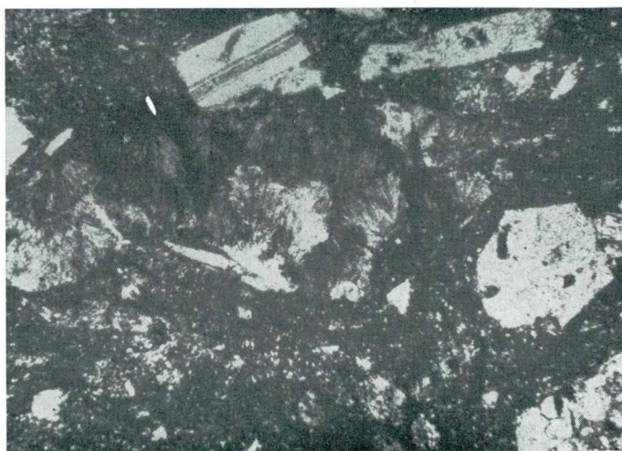
Sl. 6a in 6b, vz. 1 116 c/12 185, nikola || in +, 35 \times , Drmalka. Rdeč ignimbritni tuf z vitroklastično strukturo, Vtrošniki albitiziranega plagioklaza, velik s sferuliti kristaliziran fragment plovca. Na različnih mestih različno deformirani in sintrani drobci stekla
