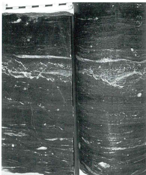
Sl. 3. Diaforit. Retrogradno spremenjen, milonitiziran biotitno-muskovitni gnajs. MB-2, glob. 487 m. Merilo je v cm.
