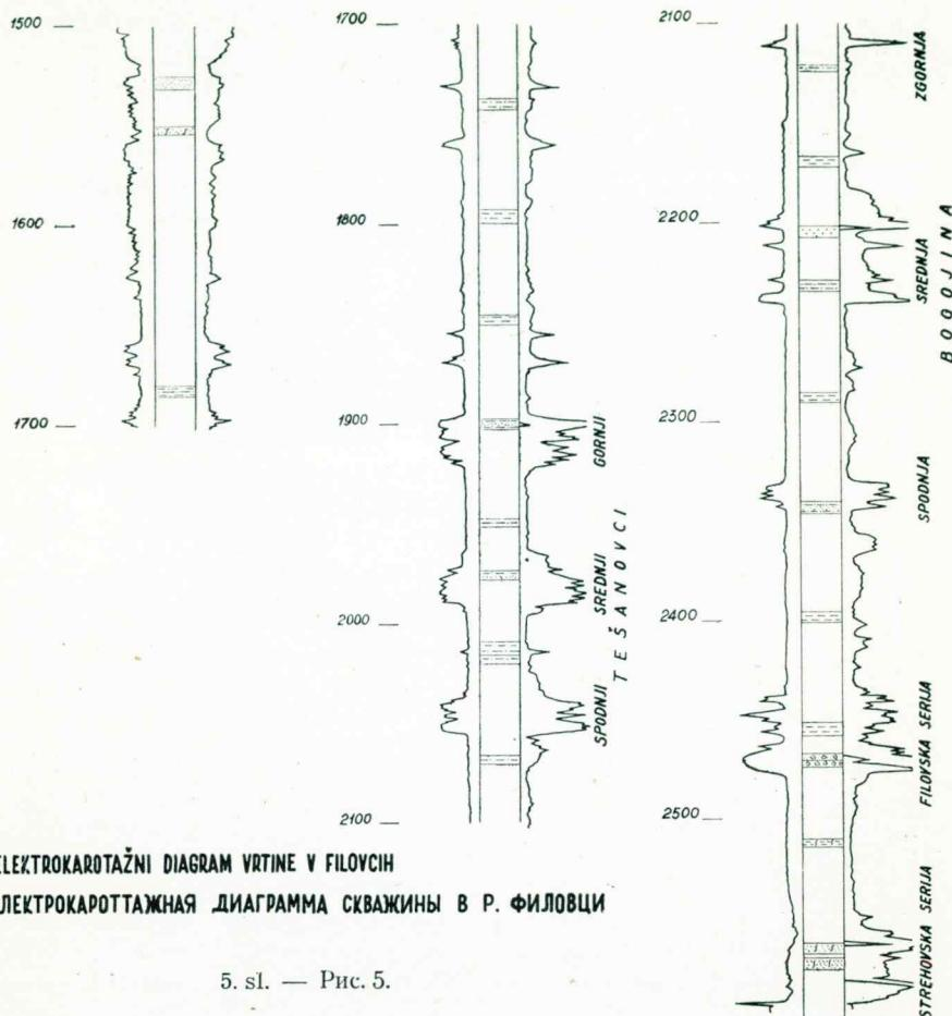
ELEKTROKAROTAJNI DIAGRAM VRTINE V FILOVCIH
