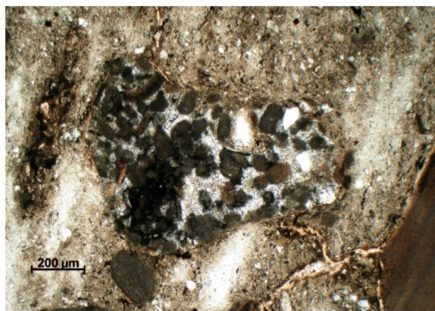
Sl. 8. Litoklast izpranega pelmikitnega apnenca v karbonatnem mulju. Vz. 3, vzporedna polarizatorja. Izkop za HE Brežice.
