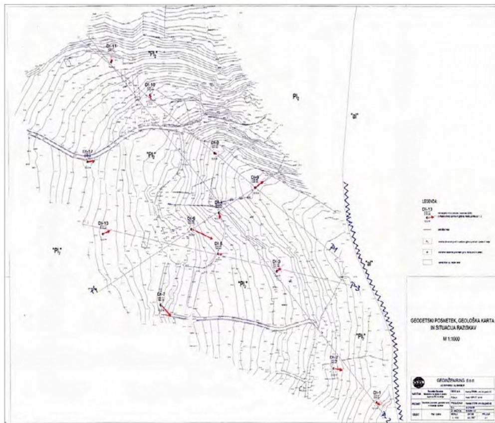
Sl. 7. Izmerjeni premiki v inklinometrih (povzeto iz ŠTERN et al., 2007).
