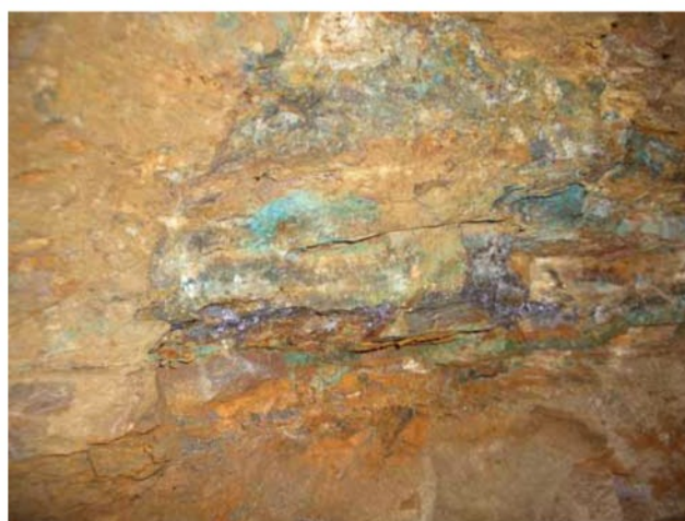
Sl. 5. Modrikasti in zeleni oprhi sekundarnih mineralov na prečnih prelomnih površinah. Vzdolž klivaža po foliaciji se nahaja predvsem sulfidno svinčevo, cinkovo, bakrovo orudenje in okremenitev (sveži odlomi v sredini slike). Remšnik, Janičkov rov. Foto Z. Žorž.
