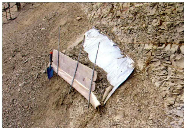
Slika 2. Gradivo (30,8 kg) ujeta za pregrado erozijskega polja 4 v tednu med 19. 1.–26. 1. 2006 (fotograf: Matija Zorn)
