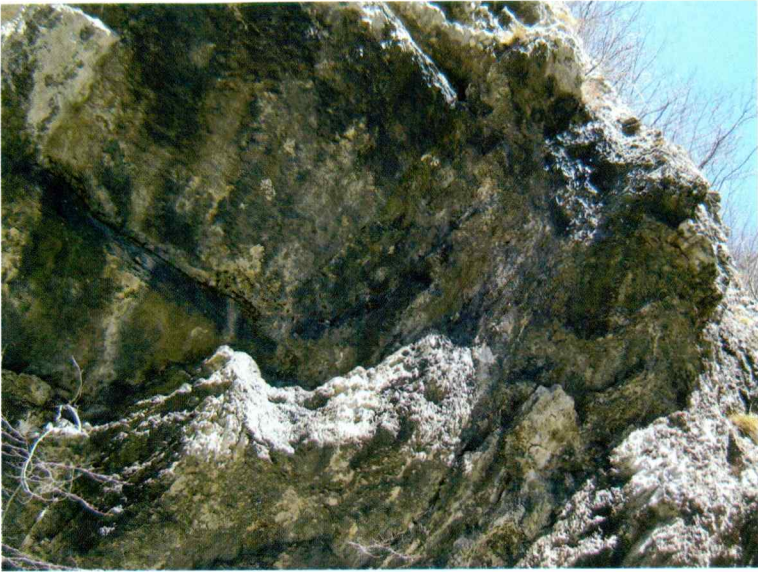
Slika 12. Razpoklinska cona pod previsom pred izvedbo sanacije: oksidirane in kalcitizirane delno odprte in kavernozne razpoke: območje GSI = 43 do 47.
