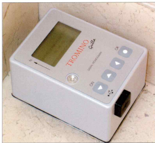
Slika 4. Seizmograf za meritve mikrotremorjev Tromino.
