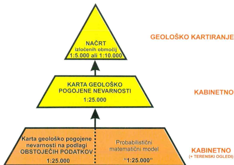
Slika 1. Shema izdelave karte geološko pogojene nevarnosti zaradi procesov pobočnega premikanja.
