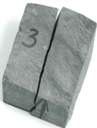
Sl. 20. Peščeni metameljevec s tankimi, nagubanimi laminami glinastega skrilavca, obremenjen pravokotno na s_1 . Vzorec 3. Dolžina spodnjega levega roba vzorca je 45 mm.
