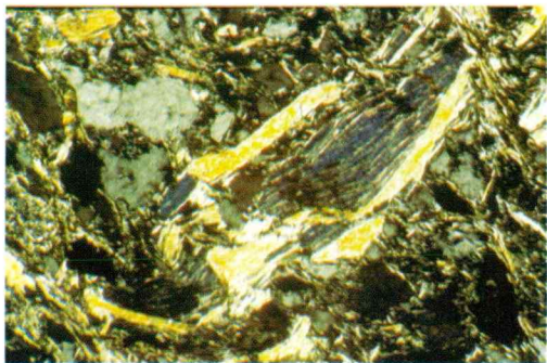
Sl. 3. Stopničasto deformiran sericitno-kloritni agregat nakazuje plastovitost prečno na foliacijo, ki poteka diagonalno od leve zgoraj, proti desni spodaj. Viden je mehansko rotiran listek muskovita in nova rast sericita v smeri s_1 + N, povečava 130 \times .
