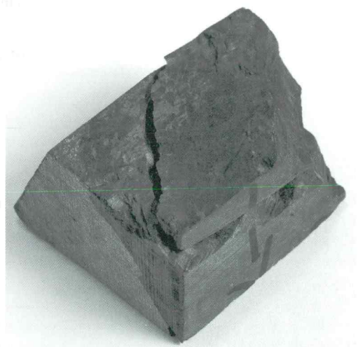
Sl. 13. Porušitev glinastega skrilavca in skrilavega meljevca s filosilikatnimi laminami pri obremenitvi vzdolž s_1 . Vzorec 5. Dolžina spodnjega desnega roba vzorca je 35 mm.
