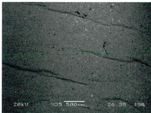
Sl. 10. Gladke površine foliacije prekrte z drobnimi listki sericita in z ostanki grafitizirane organske materije (črna). Asimetrične mikrogube nakazujejo začetne strižne deformacije. SEM BSE posnetek.
