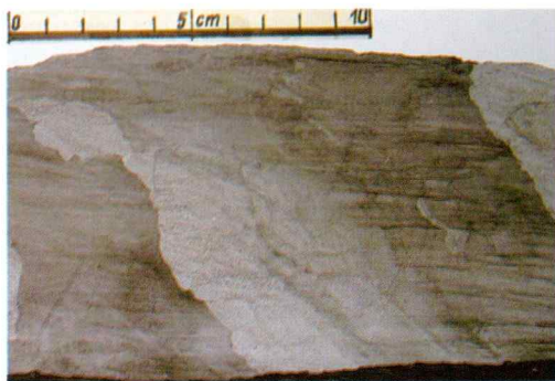
Sl. 2. Menjavanje tankih plasti glinastega skrilavca in peščenega metameljevca z navzkrižno plastovitostjo in s prečno (horizontalno) potekajočo s 1 . Šentviški hrib, stacionaža 1409.
