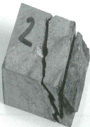
Sl. 16. Tanka plast peščenega metameljevca z drobno nagubanimi filosilikatnimi laminami vzdolž navzkrižne plastovitosti. Prečno na plastovitost je po temenih gubic razvita sekundarna skrilavost. Vzorec 2. Dolžina spodnjega roba vzorca je 35 mm.
